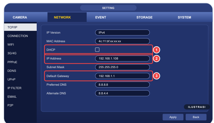
Dahua / IMOU / XVR: Main Menu ▶ Setting ▶ Network ▶ TCP/IP
